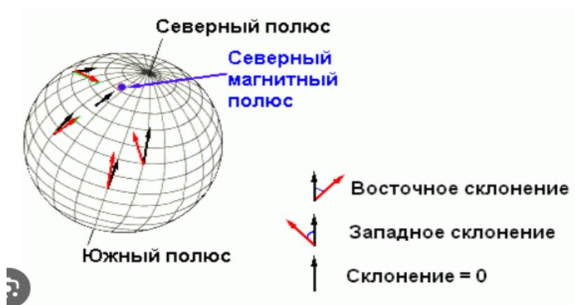
Рис.3.3 Склонение магнитной стрелки
