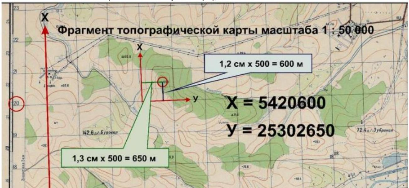
Рис.4.1 Определение прямоугольных координат
